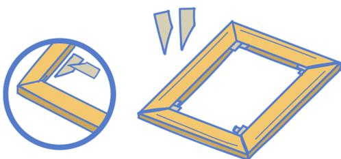
6. Après entoilage, placer les clés de tension dans les fentes situées dans les angles intérieurs du châssis.
