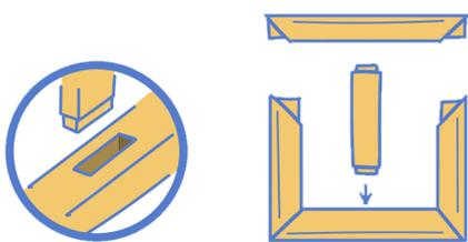
3. Si votre châssis nécessite des traverses, les insérer dans les encoches prévues.
